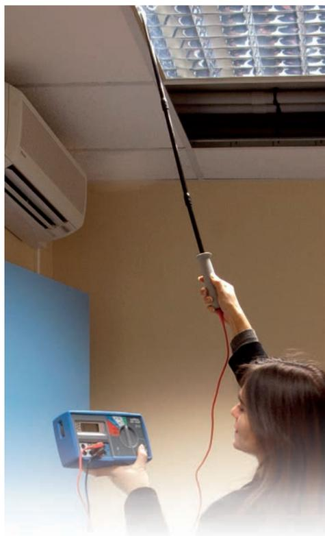
Contrôleur d'installation multifonction
