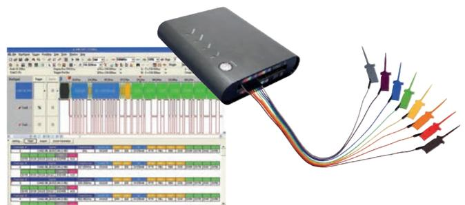
Sonde de décodage de bus autonome alimentée en USB
