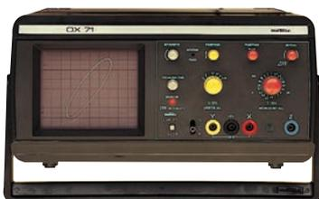
Équipé de boutons de couleur et des fiches bananes de sécurité, il, fait la référence dans le cadre de l'apprentissage de l'oscilloscope. Au niveau sécurité, le double isolement permet d'éviter les risques lors des erreurs de branchement :
